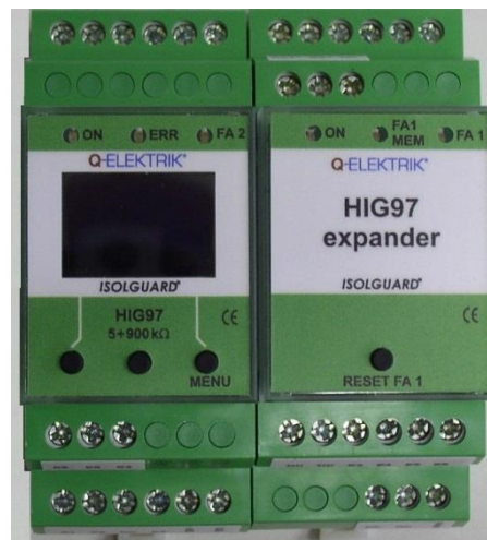
Obrázek 2 - hlídač HIG97 v provedení pro firmu Q-ELEKTRIK a.s.
