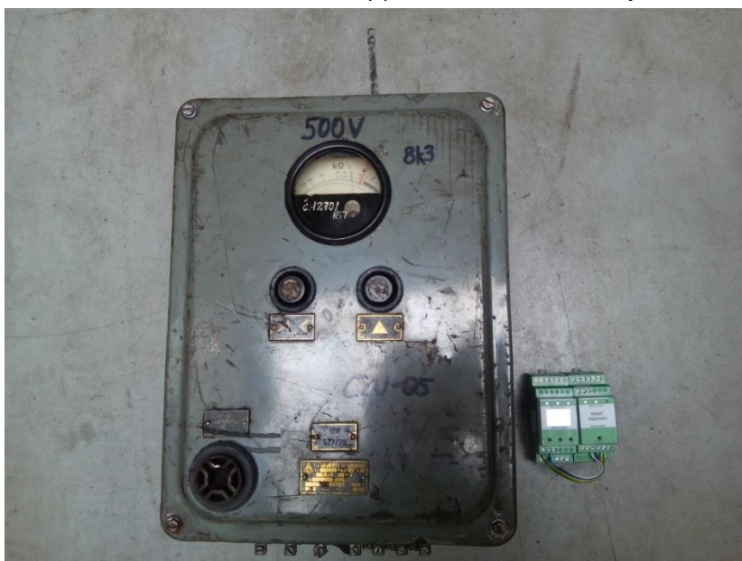
Obrázek 3 - porovnání původního hlídače typu CZU-05 a HIG97
